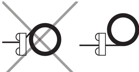
Следите за правильной намоткой троса. Неравномерная намотка может привести к выходу лебёдки из строя. Если трос начал наматываться на барабан неравномерно, прекратите намотку, ослабьте трос и поправьте его. Для равномерной укладки свободного троса на барабан слегка натягивайте трос рукой, защищенной толстой кожаной перчаткой.
